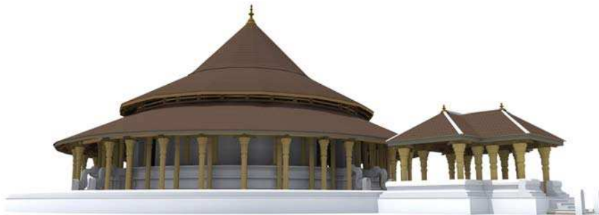
ภาพที่ 5: "ธูปาพระ" ซึ่งหมายถึงสลุปที่มีหลังคา ซึ่งในลังกามีระบบโครงสร้างหลังคาที่แข็งแรงและมีการยึดโยงกันอย่างแน่นหนา ทำให้สามารถพัฒนาโครงสร้างหลังคาให้มีขนาดใหญ่จนสามารถสร้างคลุมพระเจดีย์ทั้งองค์ได้
