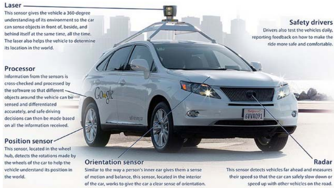
ภาพที่ 3.8 ระบบเซ็นเซอร์ของรถยนต์อัตโนมัติของบริษัท Google
